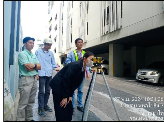
ภาพที่ 90 ตรวจสอบการทรุดตัวของพื้นที่ข้างเคียง
